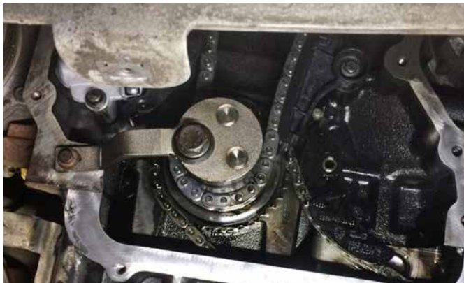
EINSTELLWERKZEUG FÜR KURBELWELLENRAD 106574
