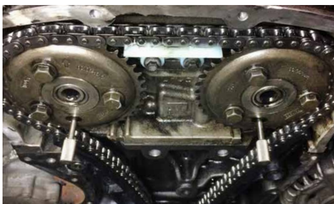
EINSTELLWERKZEUG FÜR NOCKENWELLE KT10032
