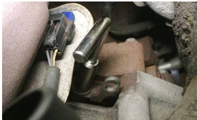
EINSTELLWERKZEUG FÜR KURBELWELLENSCHWUNGRAD 21006
