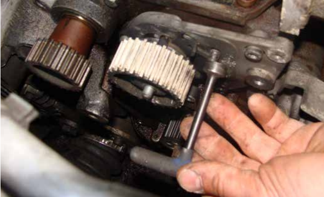
SCHLÜSSEL FÜR SPANNROLLE DES ZAHNRIEMENS 106223
