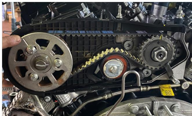
ARRETIERUNG DER HOCHDRUCKKRAFTSTOFFPUMPE
